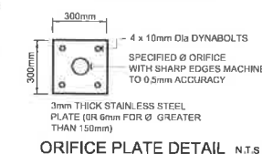
ORIFICE PLATE DETAIL N.T.S.
